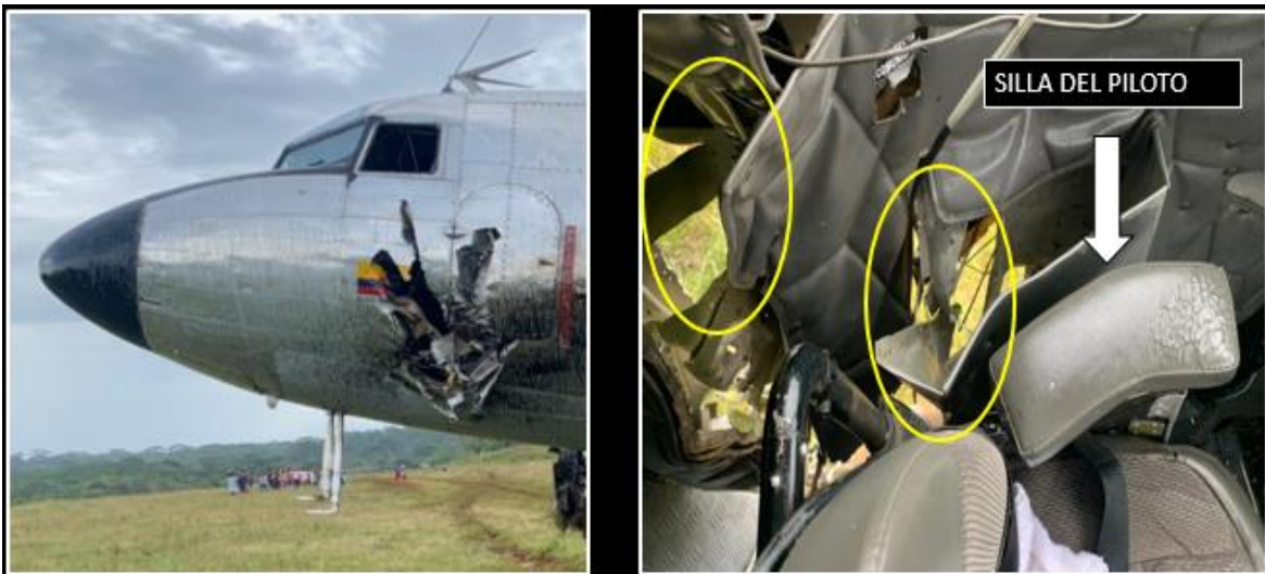
Fotografía No. 9: Daños en fuselaje izquierdo.
