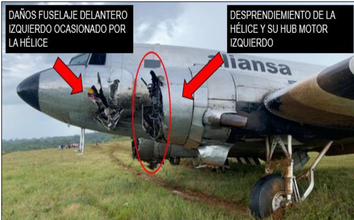
Fotografía No. 6: Daños motor y hélice.
