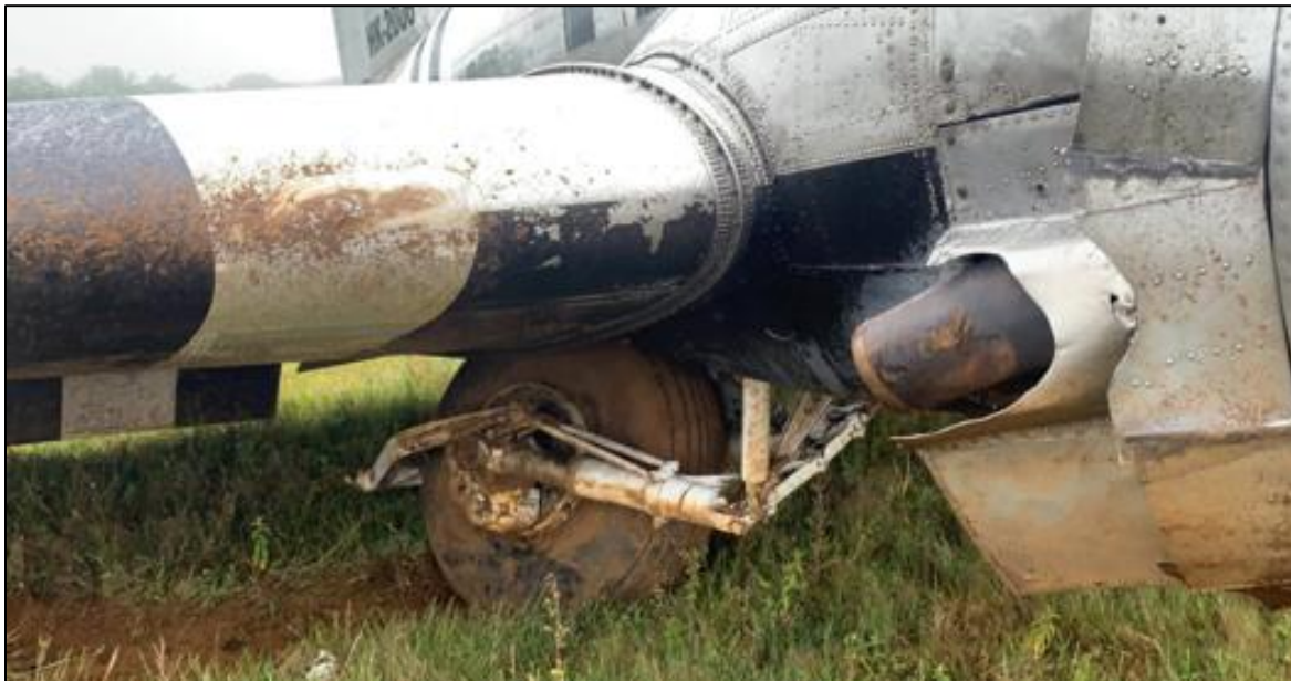
Fotografía No. 11: Daños tren de aterrizaje derecho.
