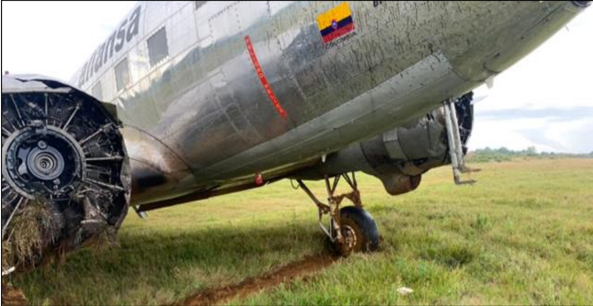
Fotografía No. 8: Daños motor derecho.
