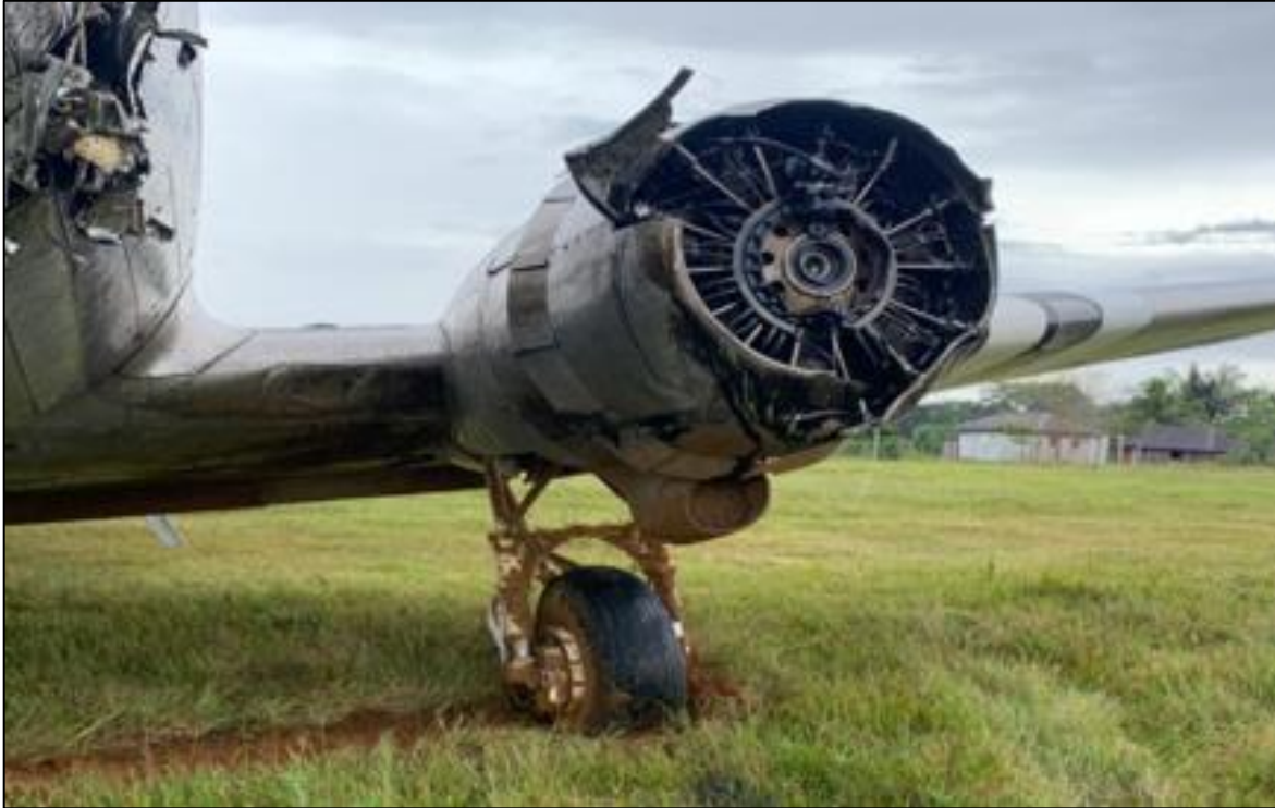
Fotografía No. 12: Daños tren de aterrizaje izquierdo.
